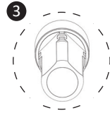
Paralelos Sistema anti-rotacional no posicionamento da cavidade do modelo prototipado.
