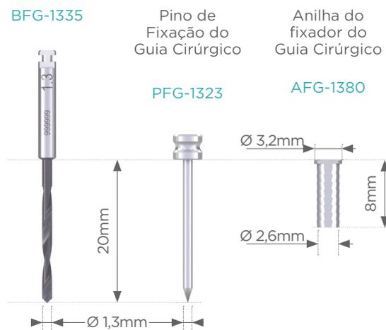
Para garantir a estabilidade, o Fixador de Guia deve ser posicionado em uma área com qualidade óssea adequada e suficiente. A Anilha Medens para o Fixador de Guia deve ter ao seu redor quantidade suficiente do material do guia cirúrgico, para uma retenção adequada. Além disso, o número de Fixadores de Guia deve ser adaptado à anatomia do paciente, ao tipo de guia cirúrgico utilizado e ao número e posicionamento dos implantes (para exemplos de posições recomendadas, observe as figuras).
