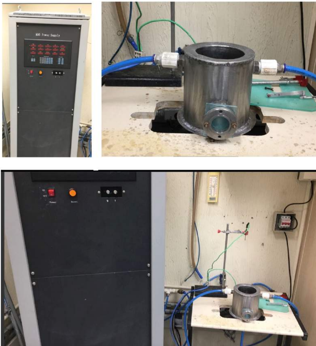
Figura 1- Sistema integrado para criação de faíscas elétricas (MAO) através da oxidação por plasma eletrolítico e incorporação pela técnica biomimética de íons cálcio e fosfato (Procedimento realizado na Faculdade de Engenharia – UNESP Sorocaba-SP).
